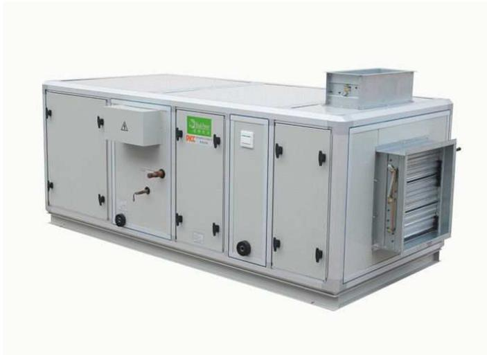
L'unità HVAC è indispensabile per il trattamento dell'aria da inviare nella camera bianca. E' formata da un tunnel in cui sono posizionate zone di prefiltri (piani ed a tasche) ed un motore elettrico collegato ad un ventilatore che invia l'aria attraverso condotti chiusi fino al soffitto della camera bianca.
